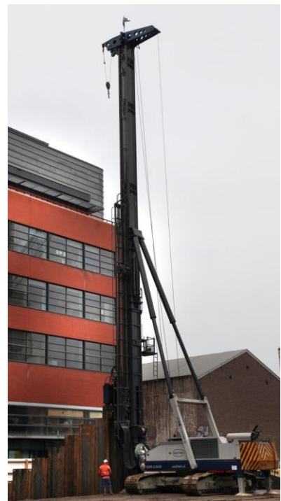
Voorbeeld van een damwand drukmachine
